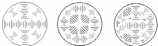
(a)垂面螺旋构型 (b)沿面螺旋构型 (c)简并螺旋构型 (a)Vertical helix (b)Parallel helix (c)Degenerate helix
